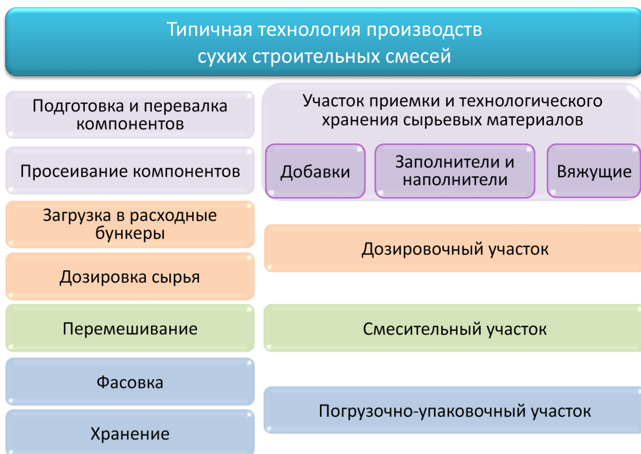
Рисунок 5.1 – Типовая технологическая схема производства сухих смесей
