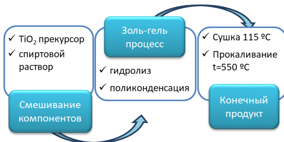
Рисунок 1.9 – Общая схема получения фотокатализаторов на основе TiO 2 золь-гель методом [110]
